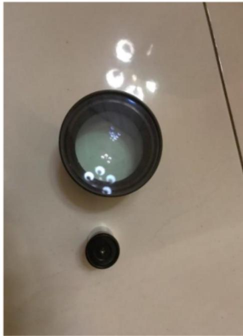
**Langkah pertama** adalah gunakan lensa fotocopy. Lensa yang akan digunakan hanya dua buah lensa (Lensa Cembung dan Lensa Cekung) dilengkapi tempatudukan lensa. Kegiatan selanjutnya adalah memotong besi melintang pada dudukan/ casing lensa fotocopy.
