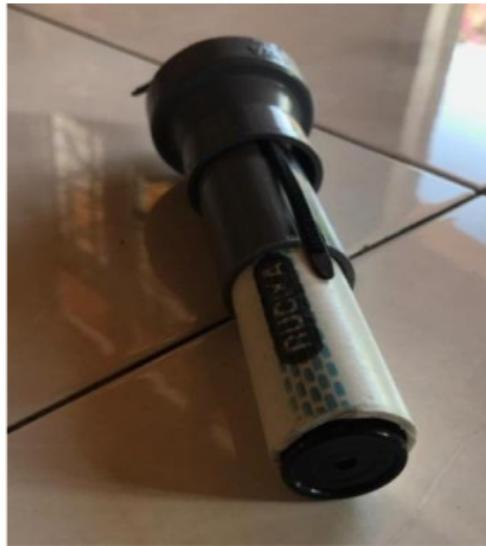
**Langkah keempat** adalah memasang lensa fotocopy pada pipa berukuran 2,5".
