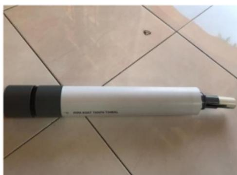
**Langkah kedelapan** merupakan langkah akhir, menyambungkan fokuser dan tabung optik. Setting lensa binokuler ke dalam lubang overshock
