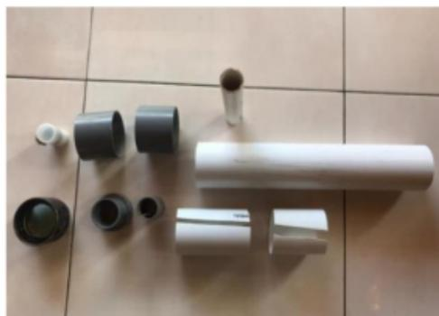
**Langkah ketiga** adalah menciptakan dudukan lensa pada pipa dengan posisi kedalaman kurang lebih 3,5cm sehingga chasis lensa dapat masuk
