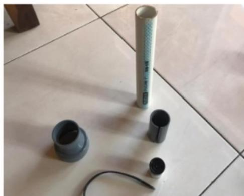
**Langkah kedua** setelah lensa telah siap, potonglah pipa paralon dengan ukuran 2,5" dengan panjang 27 cm.
